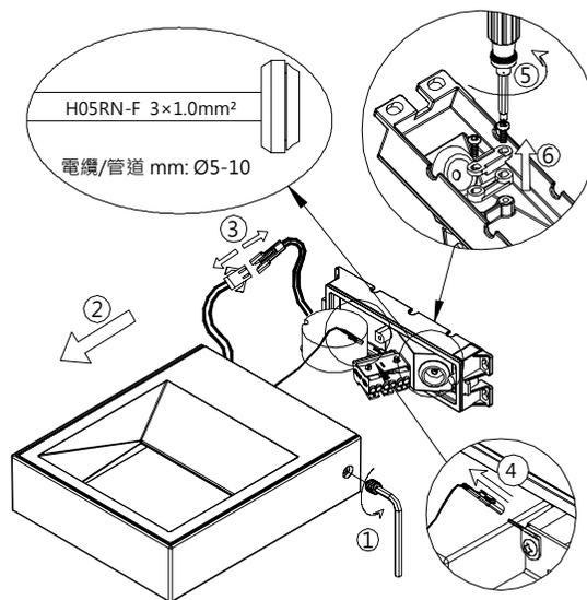
1. 斷開電源，將壁盒後蓋從燈具上取出，電纜線穿過防水塞。
