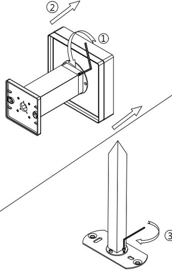
2. 鬆開螺絲取下燈體，用內六角螺絲將插地腳與底板鎖緊。
