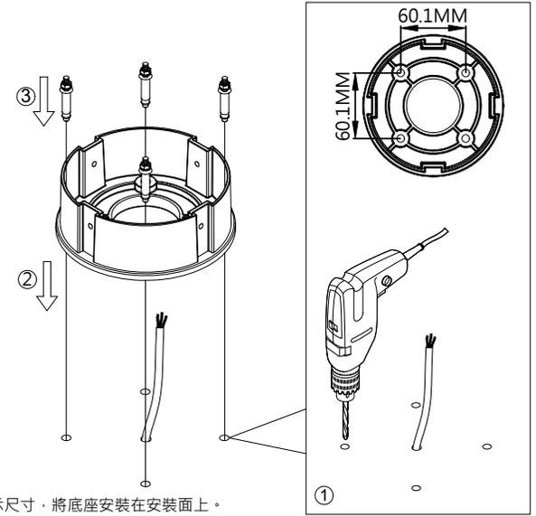
2. 按圖示尺寸，將底座安裝在安裝面上。
