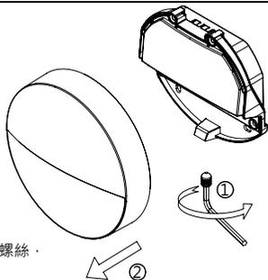
1. 用內六角扳手鬆開燈具底部螺絲, 取出燈具前面板。
