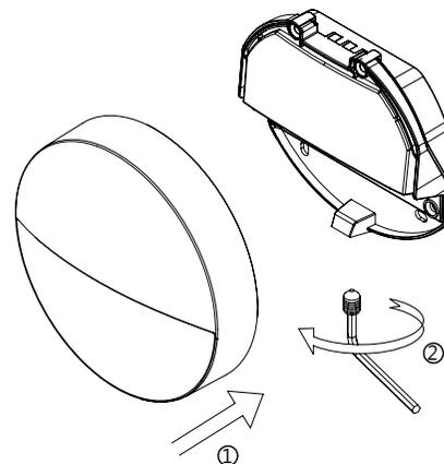
7. 將燈具前面板裝回燈具本體並用內六角螺絲將面板鎖緊。
