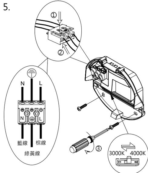
5. 將穿過壁盒防水塞的電纜線連接上燈具輸入端子, 接好端子後如圖示調節所需的色溫。
