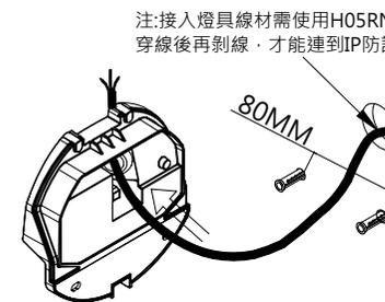
注: 接入燈具線材需使用H05RN-F 3G1.0mm<sup>2</sup>電纜線, 穿線後再剝線, 才能達到IP防護等級
