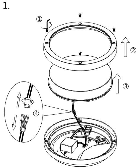
1. 斷開電源，按圖步驟拆開燈具。
