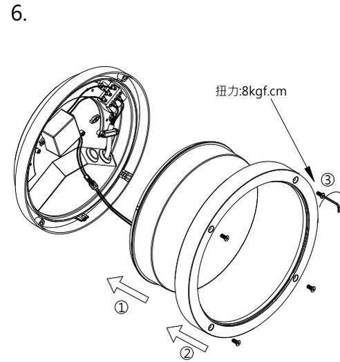
6. 按圖步驟將燈具安裝好並鎖緊螺絲。
