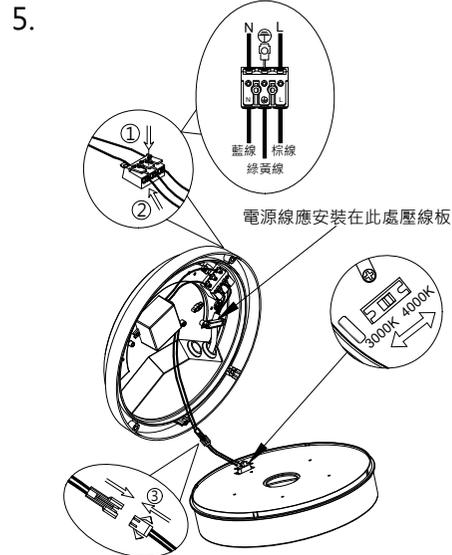
5. 將燈具連接好外部電源，調節到所需要的色溫後將燈具公母插線連接好。
