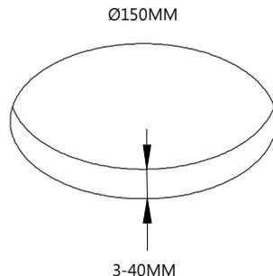
1. 斷開電源，天花板安裝面上截取適合的安裝孔。
