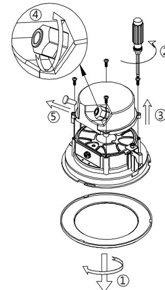
2. 將燈具的前面板與燈具後蓋取出，將固定頭逆時針旋轉扭出。
