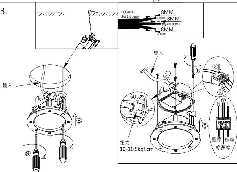
3. 將燈具連接外部電源，再將燈具按步驟順序安裝好在挖孔處。
